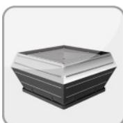
Dachventilatoren mit Außenläufermotor sind 100 % stufenlos spannungssteuerbar. Bei Ausführung mit Normmotor kommen eintourige und mehrtourige sowie spannungssteuerbare Motoren zum Einsatz.
