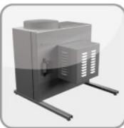
Das doppelschalige Gehäuse besteht aus verzinktem Stahlblech und ist innen mit nichtbrennbarer Steinwolle gegen Schall und Feuchtigkeit isoliert. Durch die ausschwenkbare Ventilatoreinheit ist ein einfacher Zugang zum Gehäuseinneren gewährleistet, wodurch eine schnelle und effiziente Reinigung möglich ist.
